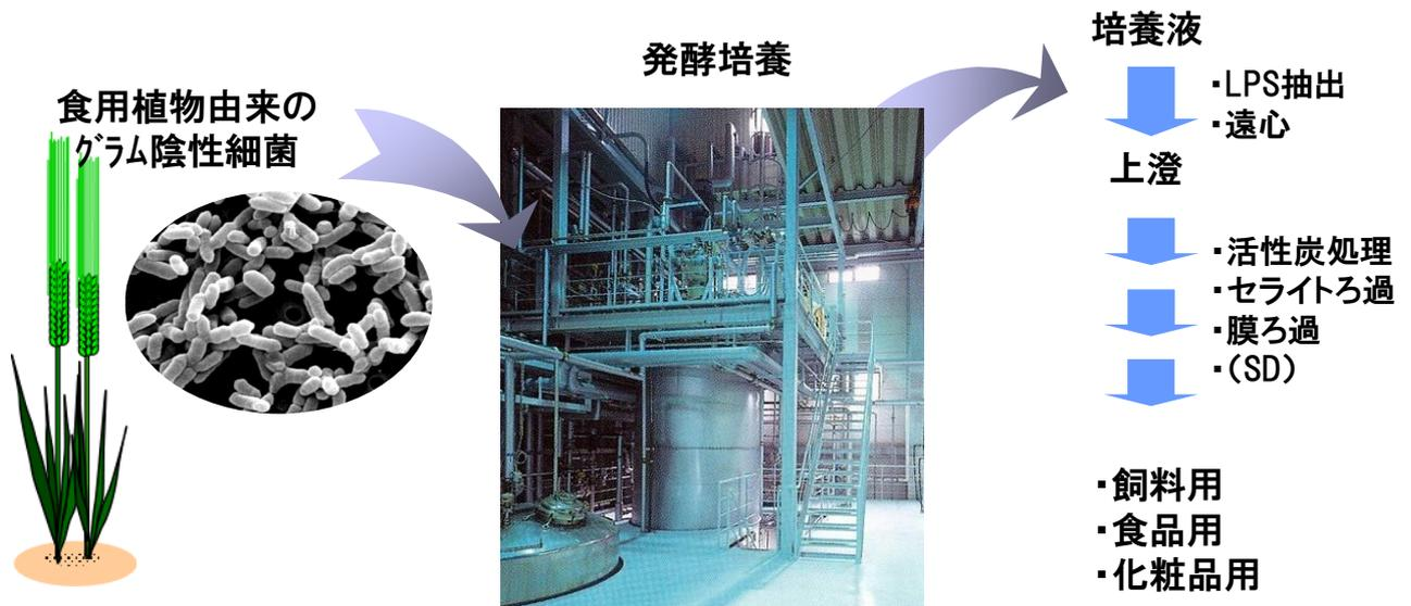
図1 LPS原料の製造工程
